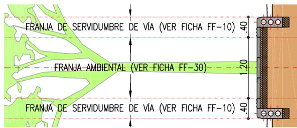
Es la zona verde o dura de la vía pública que separa dos calzadas y tiene como fin canalizar flujos de tráfico, controlar maniobras inadecuadas. Pueden ser centrales, intermedios o laterales según el tipo de sección transversal de la vía.
